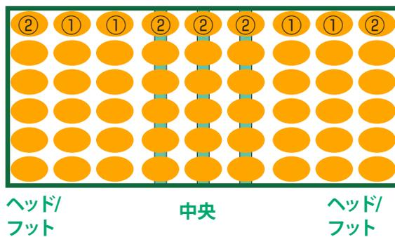
3分割方式のRELAX2000 ウッズプリングは中央部とヘッド/フット部の2種類あります。中央部は円板の下にラテックスのクッションが入っているタイプです。ヘッド/フットのうち円板の下の調整棒が2本ある方をヘッド側に寄せます。
